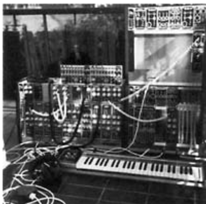
Von Markus Aigner entwickeltes Synthesizer-System.
