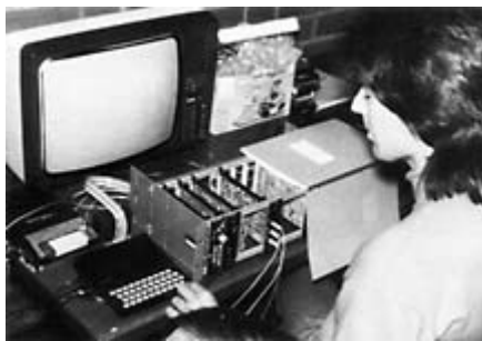
Das von Dieter Doepfer entwickelte computergesteuerte Synthesizer-System. Als Computer kommt hierfür ein kommerzieller Personalcomputer zum Einsatz.
