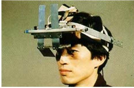
Bild 5: Ein an der Universität von North Carolina gebauter am Kopf montierter "Durchblicks"-Bildschirm, bei dem halbversilberte Spiegel verwendet werden, um die vom Computer erzeugte Bilderwelt auf die direkte Vision zu überlagern, die der Träger von seiner tatsächlichen Umgebung hat.
