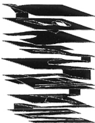
Rem Koolhaas: DIE BIBLIOTHEKEN VON JUSSIEU, 1962-63 Die Geschoßebenen werden so eingeschnitten, verformt und miteinander verbunden, daß ein koninuirliches Band entsteht.
